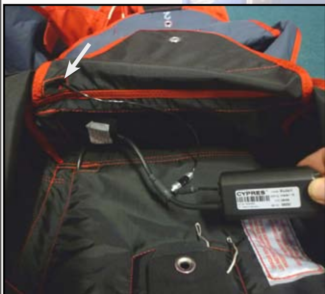
Cheminement du sectionneur Cutter cable way
