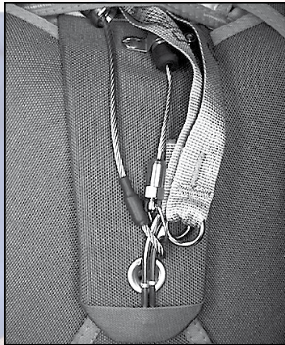
5-7-2 Fermeture du conteneur de secours avec FXC 12000 \ Reserve container closure with FXC 12000:
