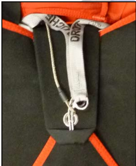
5-7-1 Fermeture du conteneur de secours avec AAD \ Reserve container closure with AAD:
