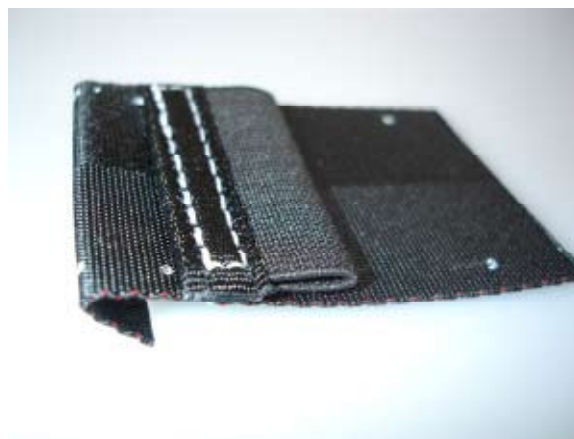
2.5 Coudre le guide élastique sur la sangle Type 12 comme illustré. Utiliser du fil Nylon E.
