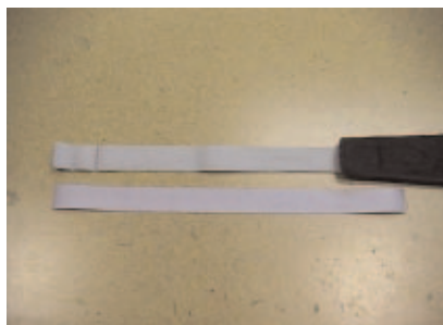
6. Coupez une longueur de sangle de type 12 comme montré en comptant 15 cm de sangle de plus pour la rentrer dans le protège cuissarde.
