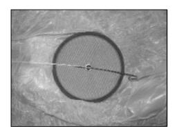
Rangez la résille et le tissu sous la calotte de part et d'autre et placez le restant dans l'axe comme sur la photo ci-dessous à gauche. Faites plusieurs plis (1 ou 2) puis verrouillez le rabat inférieur par dessus les plis. Verrouillez le rabat supérieur de fermeture avec l'aiguille de la poignée de secours. Retirez l'aiguille provisoire et la drisse de fermeture puis comptez vos outils.
