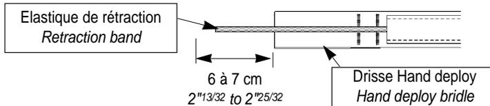
Passer l'élastique de rétraction dans l'un des deux trous de passage du galon central, puis dans le trou de la poignée de préhension (fig.4). Sortir l'extrémité de l'élastique par l'un des cotés de la poignée, pour réaliser un nœud (classique) très fortement serré, situé à 1 ou 2 cm de l'extrémité (fig.4).
