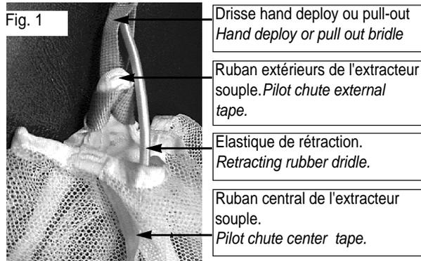
Monter la drisse hand deploy ou pull out à l'aide d'un nœud de tête d'alouette autour des rubans extérieurs et du ruban central de l'extracteur.
