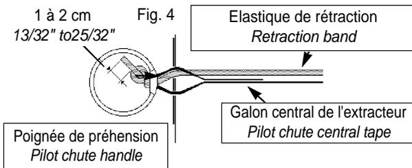
Simuler manuellement le fonctionnement de l'ensemble pour positionner définitivement le nœud à l'intérieur de la poignée.
