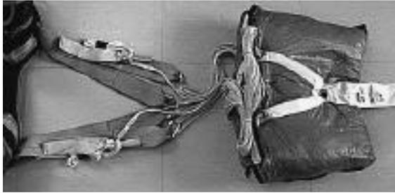
Avant de le placer dans le conteneur, compresser le POD pour en chasser l'air. *Before putting it into the container, compress the bag to spill air.*
