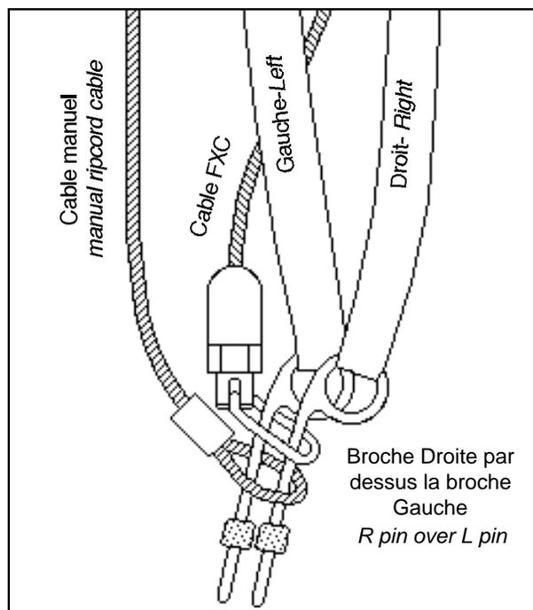
Positions du câble de traction de l'ouvreur FXC 12000 et des sangles du système LOR 2.
