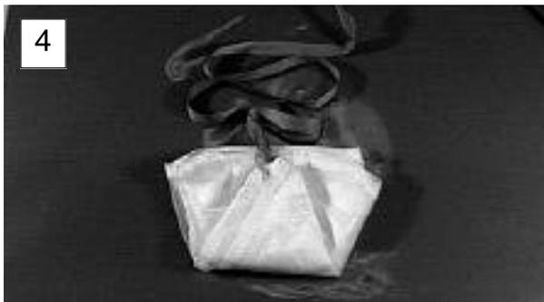
Roulez l'extracteur puis glissez le dans la pochette. *Roll the folded pilot chute and insert it into the pouch.*
