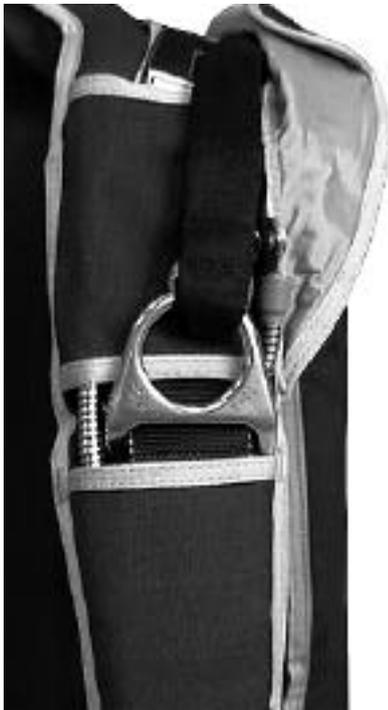
Vue du mini-élévateur monté sur le harnais.
