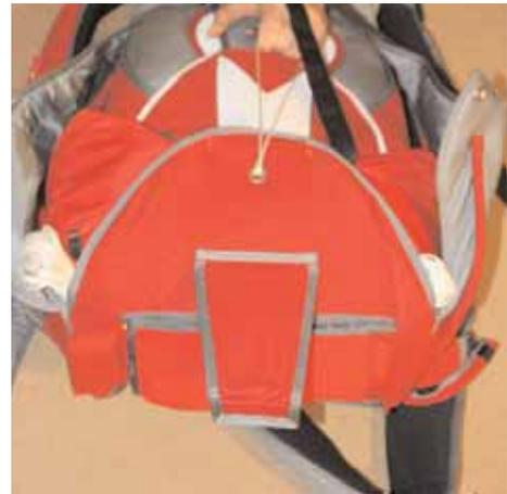
Passez la drisse de fermeture au travers de l'oeillet du rabat latéral gauche puis du droit et fermez avec l'aiguille située sur la drisse d'extracteur.
