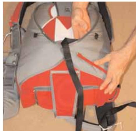
Le positionnement de la drisse doit être vertical comme sur la photo de gauche. Mettez le rabat de protection en place et rangez la drisse sous le rabat inférieur droit jusqu'au niveau de la pochette d'extracteur.
