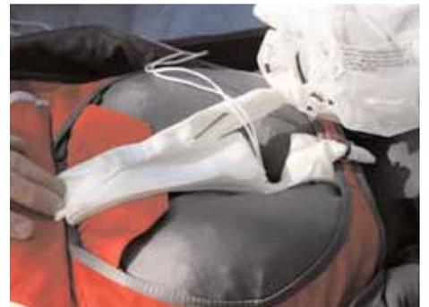
Compressez l'extracteur et verrouillez avec l'aiguille provisoire de fermeture. Dégagez le tissu et commencez à le replier en partant de la partie supérieure.
