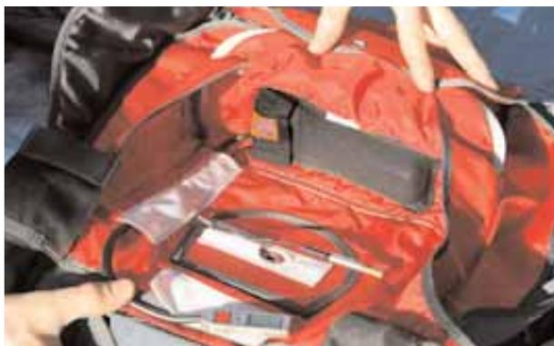
Fermez la protection velcro des câbles. Placez le couteau (cutter) dans son logement protecteur. Passez le boîtier de contrôle dans la fente prévue au niveau de l'encolure.
