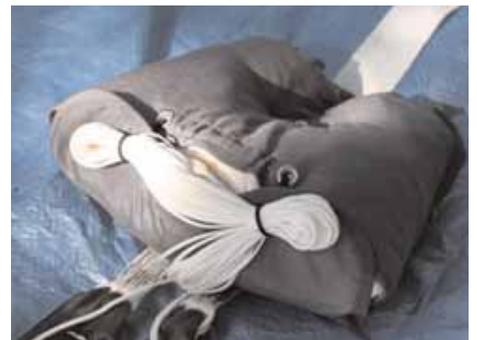
Présentation avant le conditionnement. Le cutter du déclencheur doit être placé dans son tunnel de protection et la boucle de fermeture doit impérativement passer au travers du cutter. Basculez le sac de déploiement et rangez les élévateurs en regroupant les suspentes au centre du conteneur. Faites passer la drisse de fermeture dans la boucle de verrouillage.
