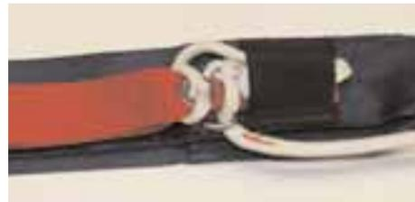
Rangez le reste des suspentes dans la pochette prévue à cet effet en faisant des S remplissant bien celle-ci. Laissez un mou d'environ 40 cm et velcrotez la pochette de lovage du sac de déploiement.
