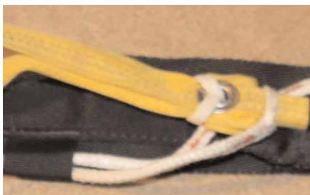
Le harnais réglable du Seven école est muni comme sur les Advance d'un codage de couleurs permettant une parfaite symétrie des sangles principales. Alignez la couleur désirée de chaque côté, pliez le reste de sangle et protégez l'ensemble avec le rabat.
