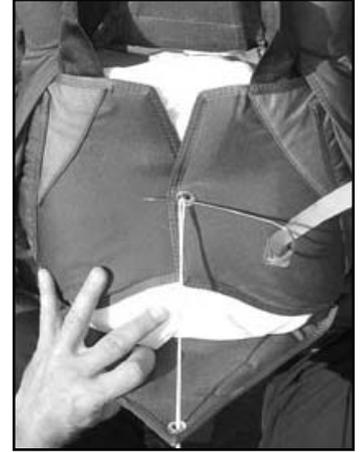
Passez la drisse au travers de l'oeillet du rabat supérieur n°6. Retirez et remplacez l'aiguille temporaire.
