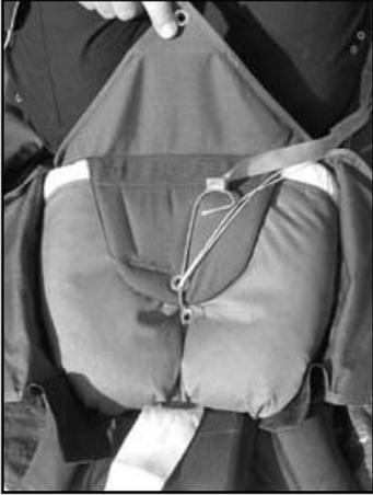
Passez la drisse de fermeture au travers du cutter du Cypres et au travers de l'oeillet du rabat n°1. Tirez la drisse, dégagez l'aiguille temporaire et remettez la en place.
