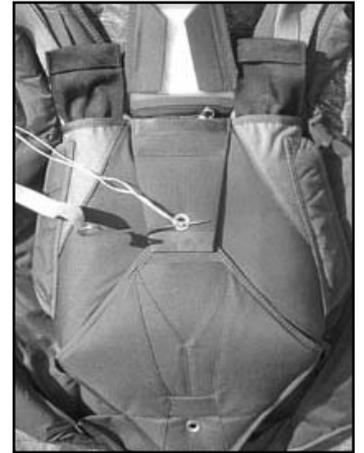
Insérez le câble de la poignée de secours dans sa gaine jusqu'à ce que l'aiguille apparaisse à l'autre extrémité et rangez la poignée de secours dans son logement. Si vous devez installer un Stevens, reportez-vous au manuel de l'Advance "Out" et suivez les instructions. Remplacez l'aiguille temporaire par l'aiguille de la poignée de secours. Retirez la drisse et comptez vos outils. Plombez le secours si telle est la réglementation dans votre pays.
