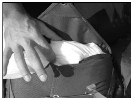
Passez la drisse au travers de l'oeillet du rabat inférieur n°5. Retirez et remplacez l'aiguille temporaire.
