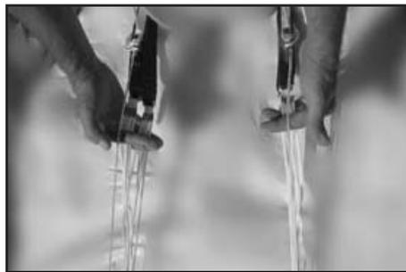
Défaites les deux rétractions du glisseur qui sont dans la position de la photo de gauche en faisant passer les 2 ergots dans les tunnels respectifs et en tirant sur les deux largeurs du glisseur afin de le ramener à sa position de pliage.
