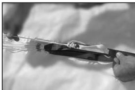
Dès les freins mis, le positionnement des élévateurs doit être identique à la photo ci-dessous.
