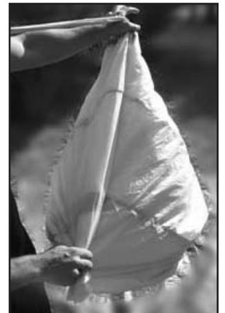
Maintenant votre voile ressemble à un boudin. Posez délicatement l'ensemble sur le sol en maintenant la tension des suspentes.
