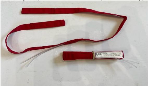
soit le changement du sac de déploiement avec une sangle de déclenchement directe avec double jonc sans nœud de liaison.
