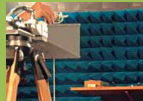
Mesure du rayonnement électromagnétique de l'Argus.
